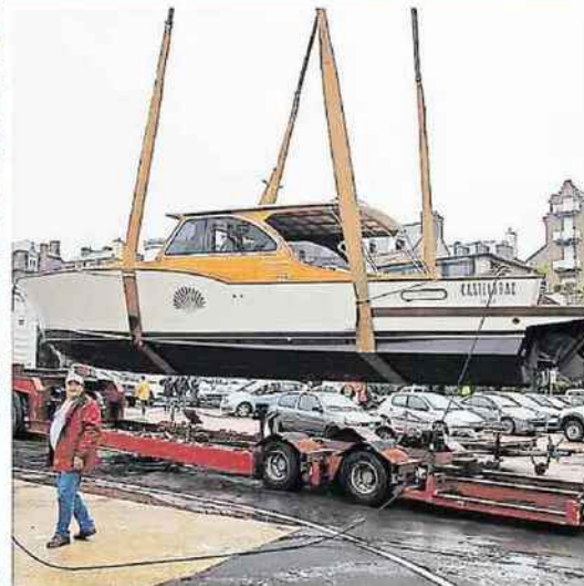
Ce véritable bijou arrive tout droit du chantier naval Dubourdieu, à Gujan-Mestras en Gironde. Il mesure 13 m de long pour un peu plus de 3 m de large. Il pèse 9 tonnes environ.
